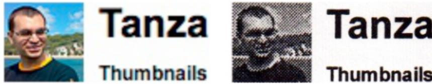
Slika 16: Primjer ispisa polutonskom tehnikom (prilagođeno od Cáceres et al., 2013).
