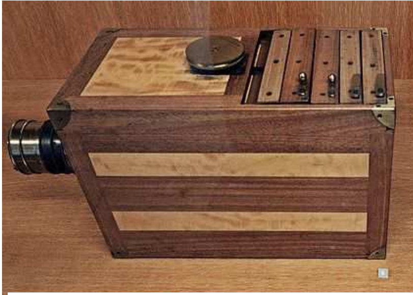
Sl. 1. Camera obscura za izradu dagerotipija.
