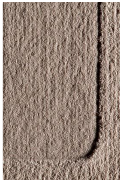
Slika 6. Karakteristični trag od pritiska matrice na papir kod dubokog tiska
