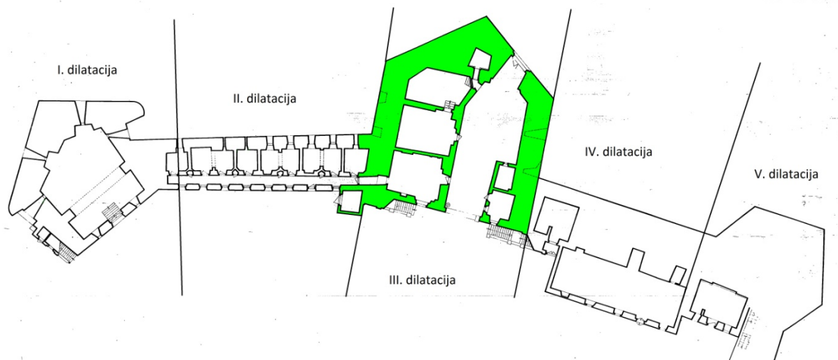
Slika 22. Tlocrt prizemlja današnjeg stanja III. dilatacije podijeljen u četiri dijela: kolnicu (prolaz) na istočnom dijelu i tri manje pravokutne prostorije na zapadnom dijelu rastvorene vratnicama prema kolnici (tlocrt: arhiva – Restauratorski zavod Hrvatske, 1989.)
