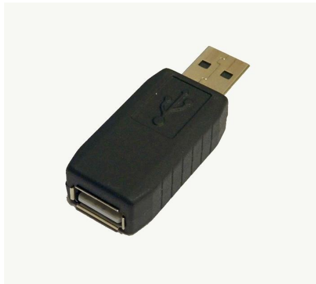
Primjer hardverskog keyloggera.
