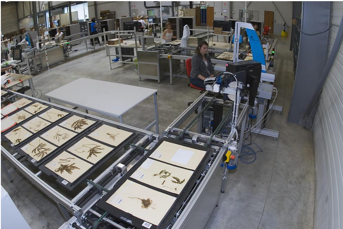
Slika 16. Digitalizacija herbarija pomoću pokretne trake
